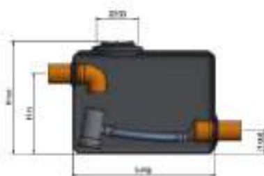
Pozzetto di cacciata
